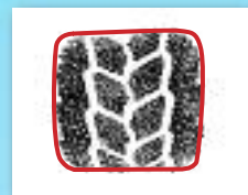
Kontaktná plocha pneumatiky predošlej generácie MICHELIN Agilis Snow-Ice
